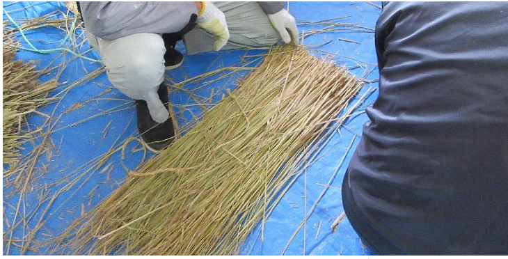
わらの中央に吊るす（抜け止めのごぶ付）縄を入れる
